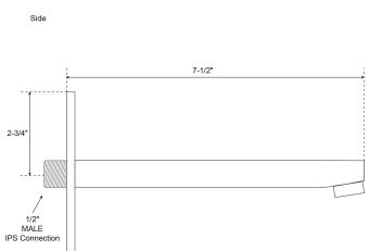
Max 4 GPM / 15.1 LPM (tub Spout)
